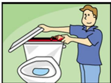
**2.** Aguarde um período de 30 minutos sem utilização da bacia. Se, após este tempo, houver água com corante na bacia, é porque existe algum tipo de vazamento.
